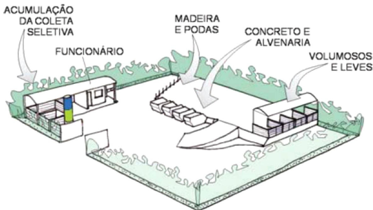
Figura 68: Desenho esquemático de um ECOPONTO FONTE: MMA (2012).
